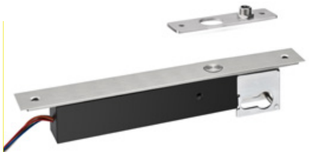
IN.28.503 Fechaduras eléctrica "DROP PIN" para cilindro europeu. Função aberto, só fecha com corrente eléctrica. A porta fica aberta com falha de corrente / Electric drop pin lock for european cylinder. Open function, only lock with electric power. The door stays open when there is no power / Cerradura eléctrica "DROP PIN" para cilindro europeu. Funcion abierto, solo cierra con energia electrica. La puerta se queda abierta con corte de energia.
