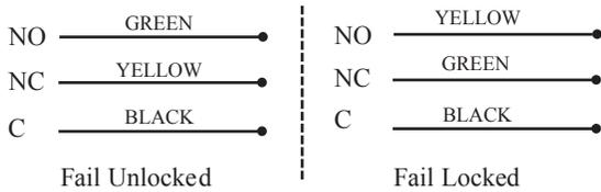
**2. Door Monitor Switch Wiring Diagram**
